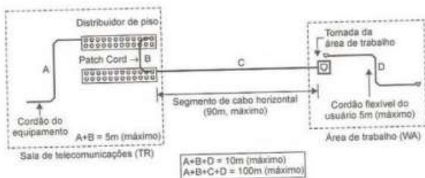
FIGURA 1 – Subsistema de cabeamento horizontal.
